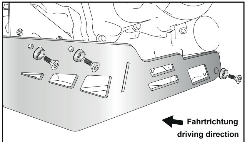
**6** Montage Frontblech Motorschutzplatte:
