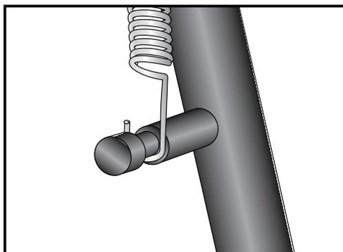
**7** Die Federn werden unten an der dafür vorgesehenen Aufnahme am Hauptständer eingehängt.
