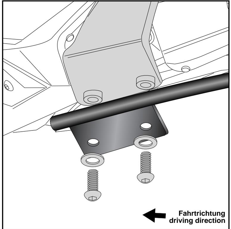
Montage der Rohradapter rechts/links hinten:
