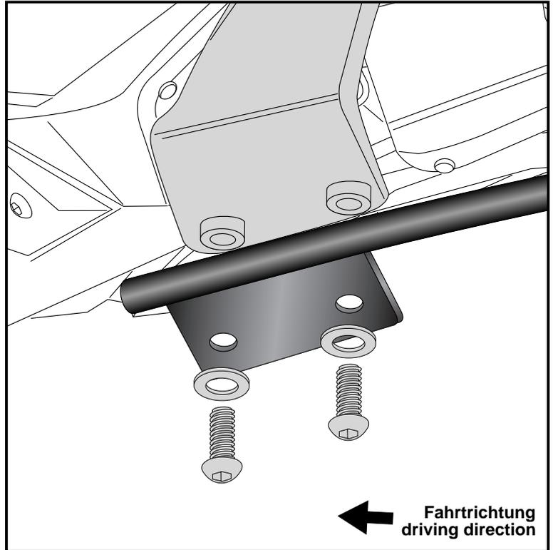
Montage der Rohradapter rechts/links hinten: Die Montage erfolgt an den nun freien Gewindebohrungen mit den Inbusschrauben M8 x 85.
