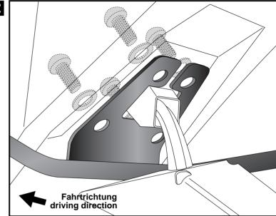
Montage der C-Bow links + rechts: An den montierten Adaptern.
