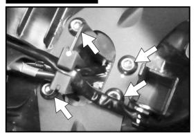
Den Soziussitz entfernen, die Kunststoffklappe öffnen und die 4 Schrauben der Kennzeichenhalterung entfernen (siehe Bild) Jeweils die hintere Schraube der Soziusfußrastenhalterung entfernen, alle Schrauben entfallen.
