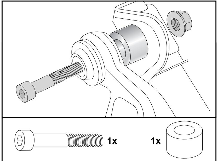
Montage Rohradapter hinten links/rechts:
