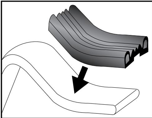
Das selbstklebende Gummiprofil in zwei gleiche Teile schneiden und wie gezeigt, auf die Oberseite der Haltetaschen zum Schutz aufkleben.
