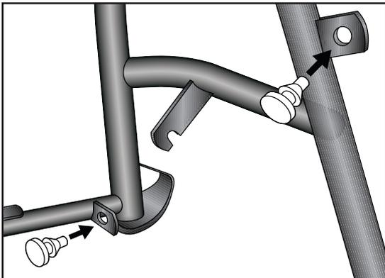
Die Anschlaggummis in die Bohrungen links und rechts des Hauptständers drücken.
