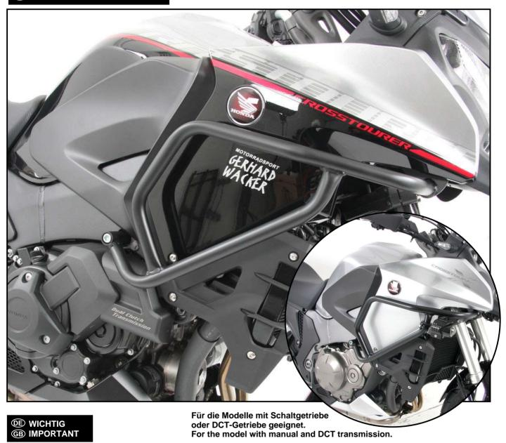
Bei der Montage der Motorschutzbügel immer nur eine Seite nach der anderen montieren - dies verhindert ein Absenken des Motors.
