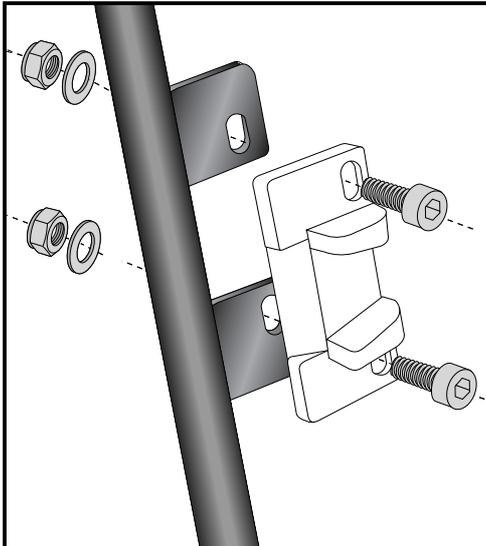
Montage des Metalladapters zum Einhängen des Kofferhalteschlusses
