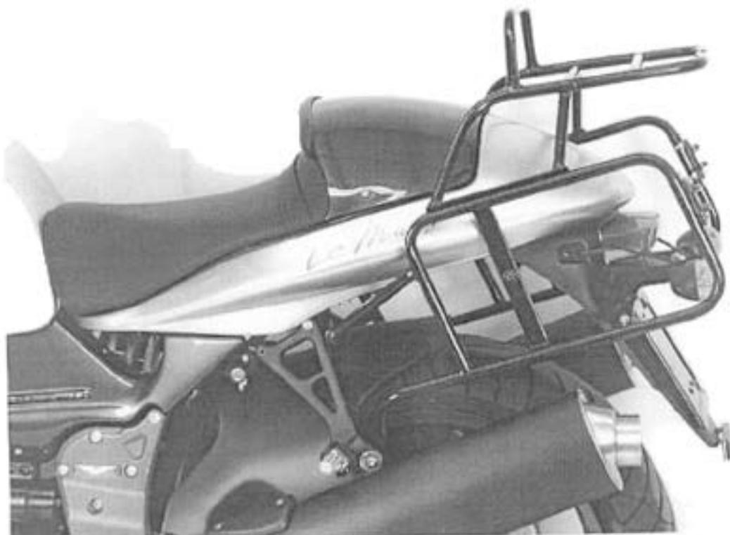
**Die TÜV-Prüfung des Systems für die Moto-Guzzi V 11 Sport ergab, daß nur die Montage der Junior 30 als Seitenkoffer, sowie des Topcases Junior 40 zugelassen sind. Die Verwendung anderer Koffer kann zu unkontrollierbaren Fahrwerksunruhen führen!**
