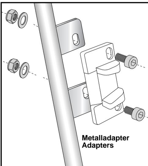
**Montage des Metalladapters zum Einhängen des Kofferhalteschlusses**
